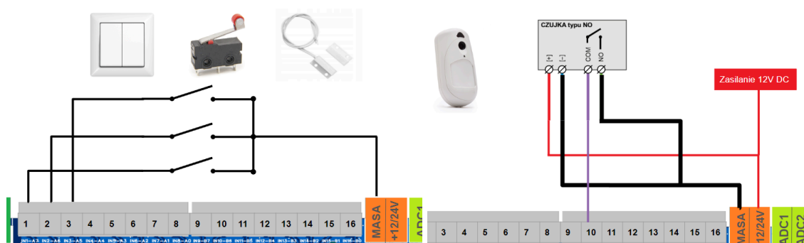
Sposób podłączenia przełączników do gniazd sterowania lub czujki ruchu
